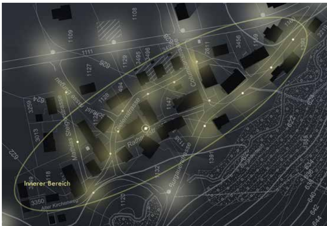
Beleuchtungskonzept, abgestimmt auf die Berechnungen der Firma BURRI public elements AG. Es wurde im Ortskern ein niedriges Niveau der Beleuchtungskörper von 4.50 m (Lichtraumprofil) angestrebt.
